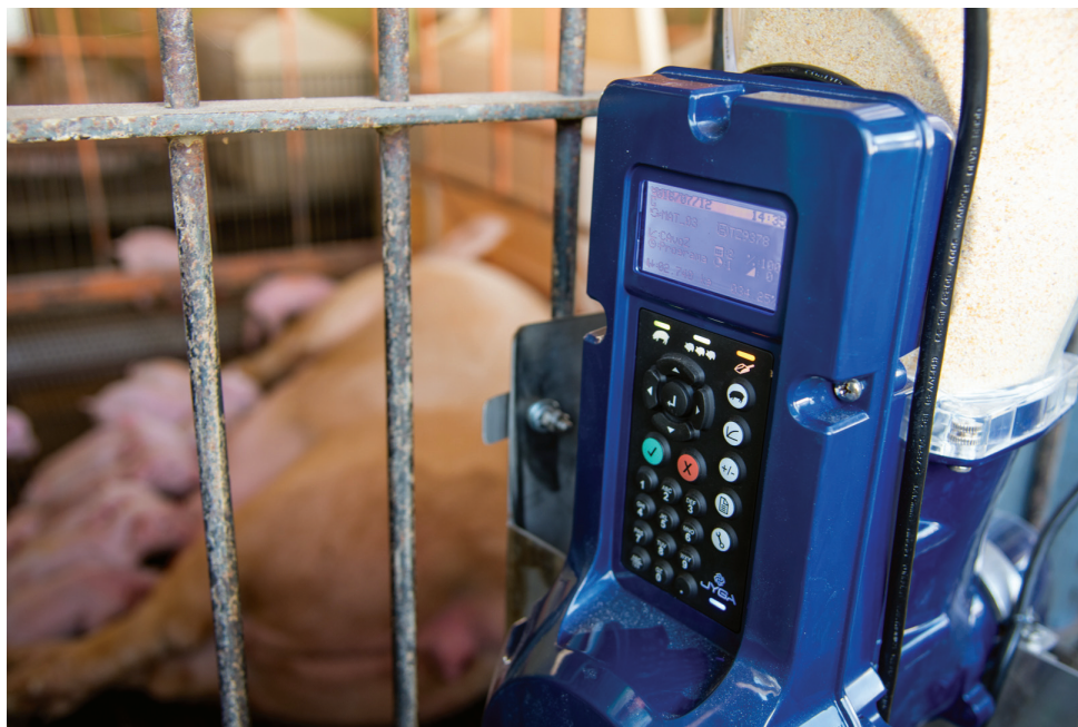
Comedouro automatizado armazena dados sobre alimentação dos animais
