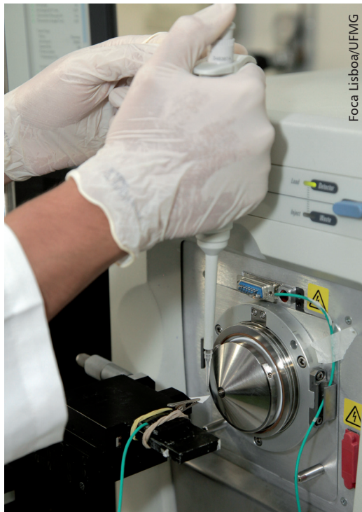
Análises são realizadas no espectrômetro de massas
